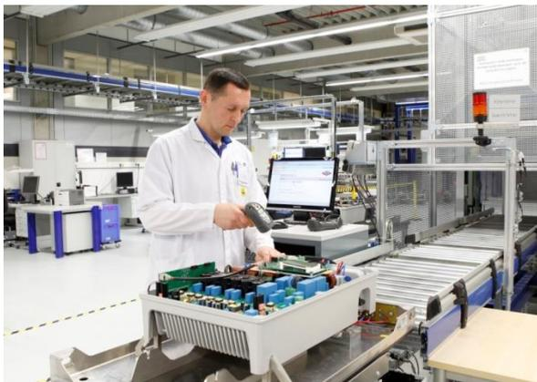
Photovoltaik-Wechselrichterproduktion bei KACO new energy in Neckarsulm.
